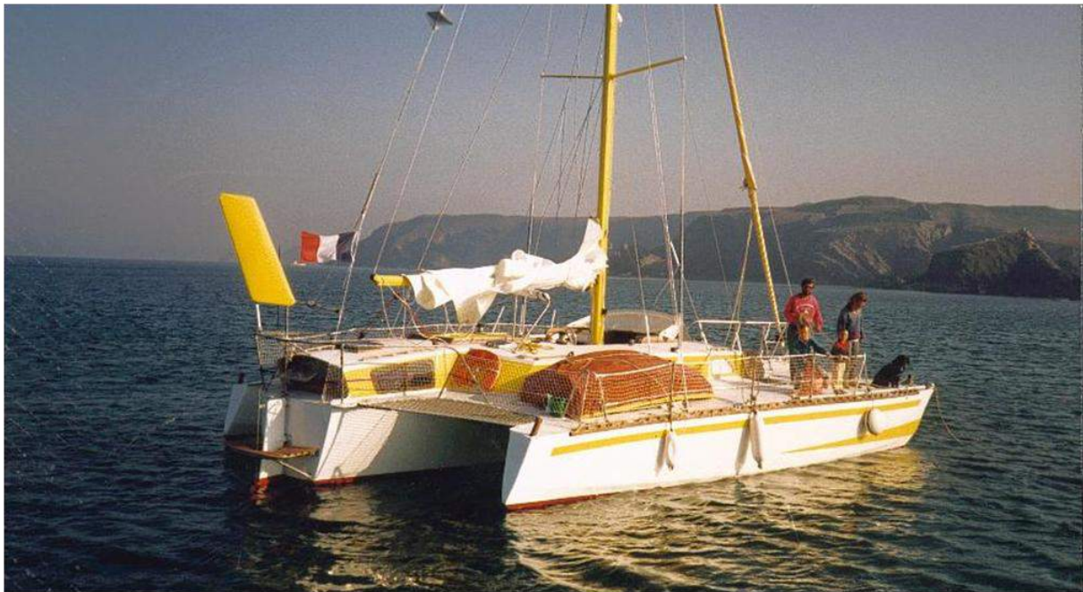
« Tropic bird » Contre plaqué CTBX et marine, collé époxy sans vis ni clous en 1991, navigue toujours du côté de la Nouvelle Zélande.
