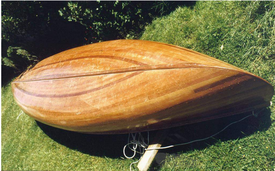
Canoë canadien en strip planking, construit sur moule sans structure intérieure.
